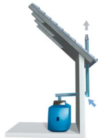
Raumluftunabhängige Aufstellvariante mit Rohr-in-Rohr-Kunststoff-Abgassystem entlang der Außenfassade
