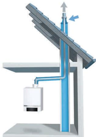
Raumluftunabhängige Aufstellvariante mit eingezogener Kunststoff-Abgasleitung im Schacht (geeignet zur Luftansaugung über den Ringspalt des Schachtes).
