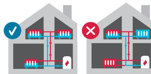
In einem gut eingestellten Heizsystem transportiert die Pumpe warmes Wasser gleichmäßig in alle Räume, während abgekühltes Wasser wieder zurück zum Heizkessel fließt.
